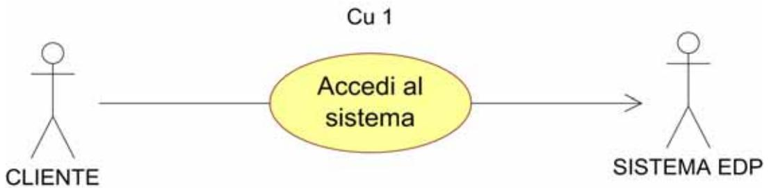
Figura 7. 3 Diagramma del caso d'uso "Accedi al sistema"
