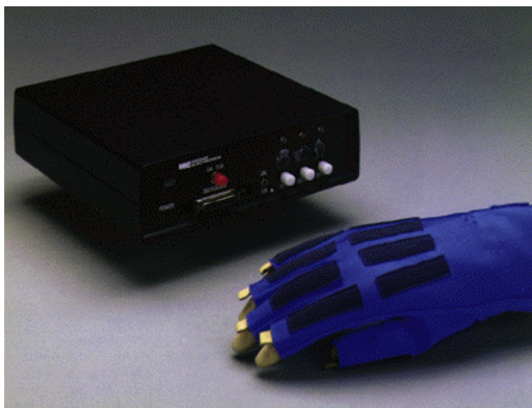
Fig 36. Superglove. Sistema con ricevitore ad ultrasuoni
