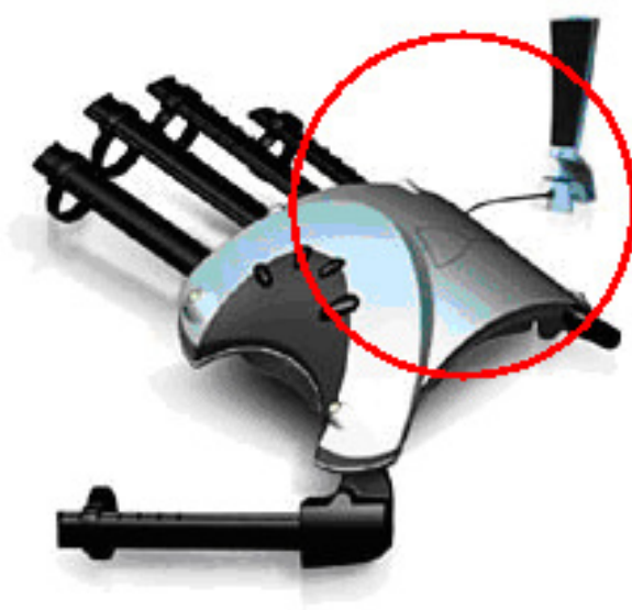
Fig 35. Glove P5. Sistema con connessioni fisiche tra ricevitore e periferica
